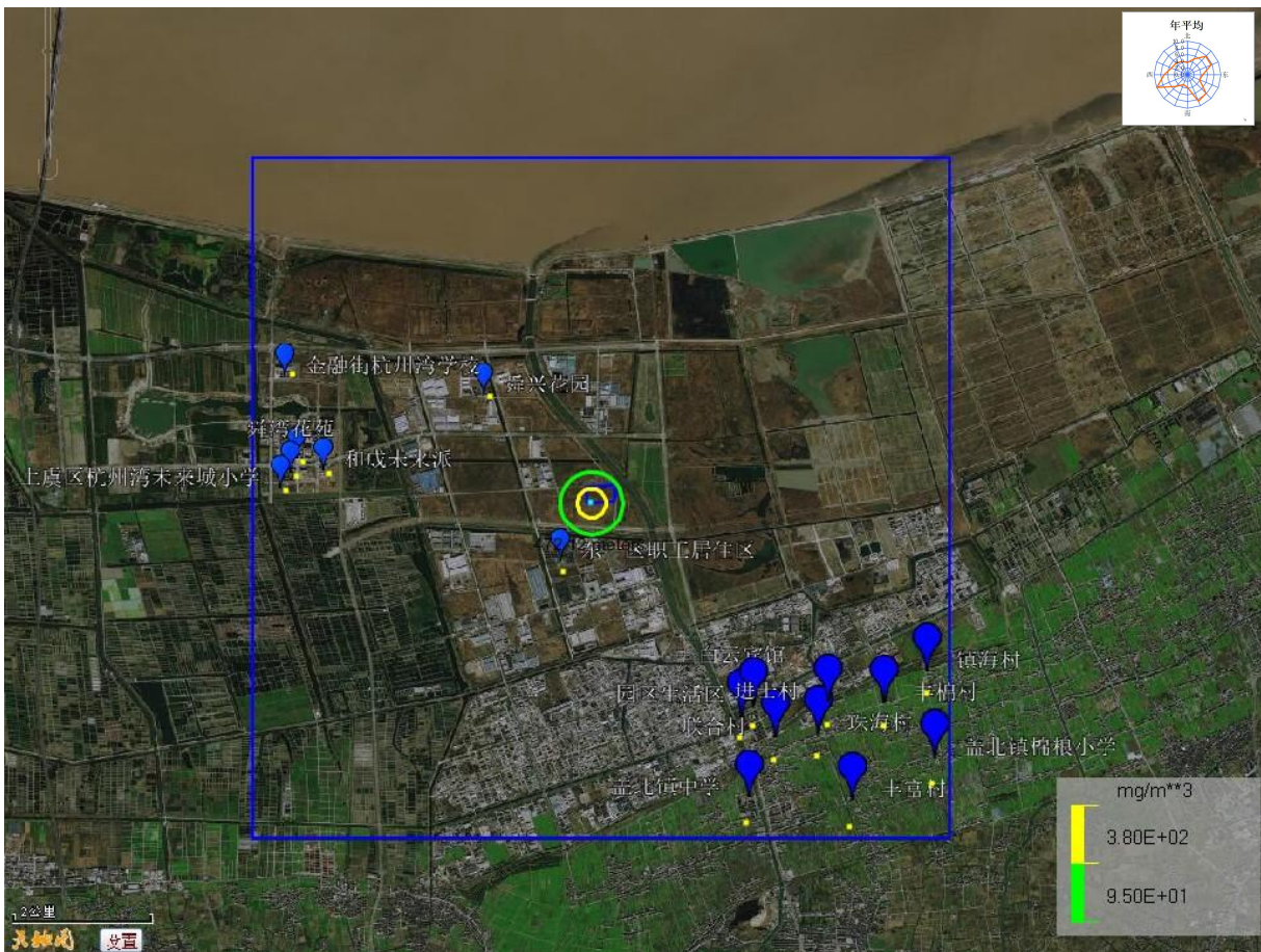
图6.10.5-2 最不利气象条件下、危废暂存库火灾事故中伴生/次生CO排放预测结果
